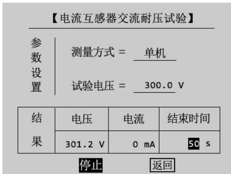
图 3.25 CT 交流耐压试验中
